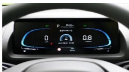
Pilnībā digitāls 4,2" LCD instrumentu bloks
