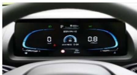
Pilnībā digitāls 4,2" LCD instrumentu bloks
